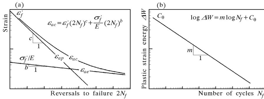
Fig. 1. Fatigue life diagrams
