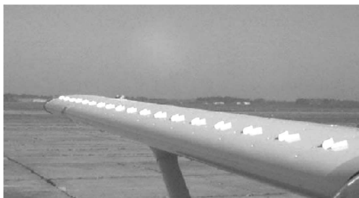
Rys. 2. Kontrrotacyjne skrzydełkowe generatory wirów umieszczone na skrzydle samolotu Cessna
