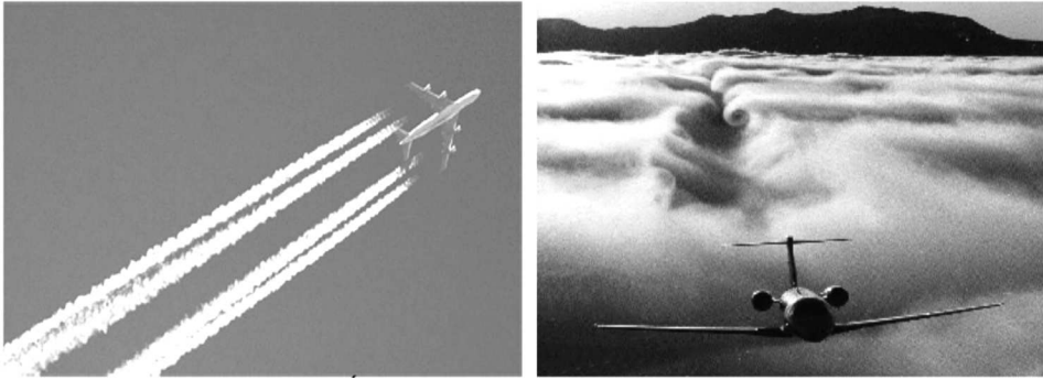
Rys. 1. Ślad wirowy generowany przez samolot
