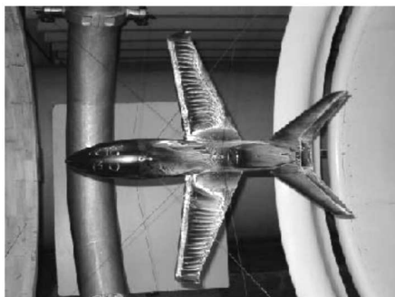
Rys. 10. Wizualizacja opływu samolotu Taxi-Jet z widocznym oderwaniem w przykadłubowej części skrzydła
