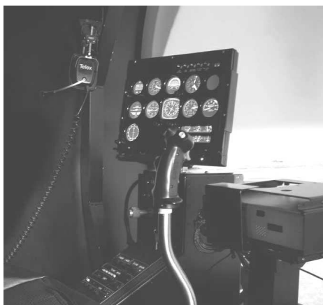
Rys. 8. Symulacja tablicy przyrządów za pomocą ekranu LCD (źródło: ETC Environmental Tectonics Corporation)
