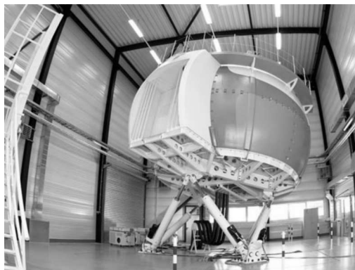
Rys. 5. Symulator samolotu MiG-29 z systemem AVIOR® (źródło: Rheinmetall Defence Electronics)
