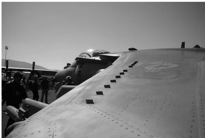
Rys. 1. Współrotacyjne skrzydełkowe generatory wirów umieszczone na skrzydle samolotu Harrier
