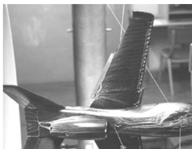
Rys. 12. Wizualizacja opływu samolotu Taxi-Jet z klapami i slotem przykadłubowym
