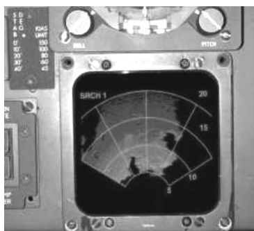
Rys. 10. Imitator radaru pogodowego i przeszukującego RDR-1300 (źródło: BVR Systems)
