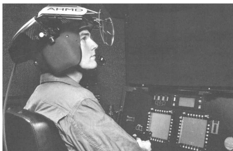
Rys. 14. AHMD wbudowany do urządzenia RCTDs (źródło: L3 LinkSimulation & Training)
