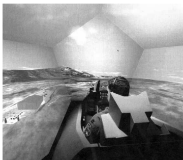
Rys. 22. System wizualizacji SimuSphere zintegrowany z kabiną symulatora F-16 (źródło: L3 Link Simulation & Training)
