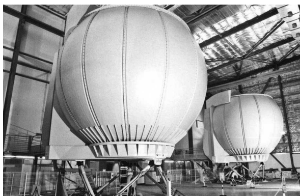
Rys. 6. Symulatory Full Flight Mission do śmigłowca Tiger dla Australijskiego Lotnictwa Sił Lądowych (źródło: Thales)
