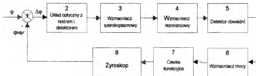
Rys. 1. Schemat blokowy żyroskopowego koordynatora śledzącego
