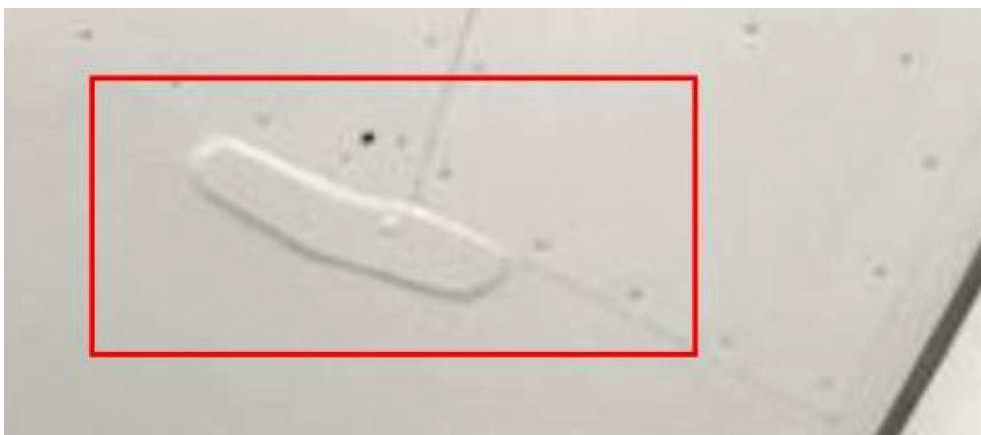
Rys. 2. Naprawa wykryta w trakcie inspekcji samolotu
