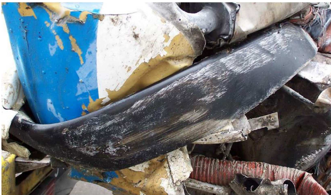
Rys. 3. Charakterystycznie duże uszkodzenia śmigła pracującego na wysokich obrotach po zderzeniu z twardym podłożem (skałą); śmigło oderwane od samolotu i pozbawione jednej łopaty [źródło: Raport nr 660/13 PKBWL]
