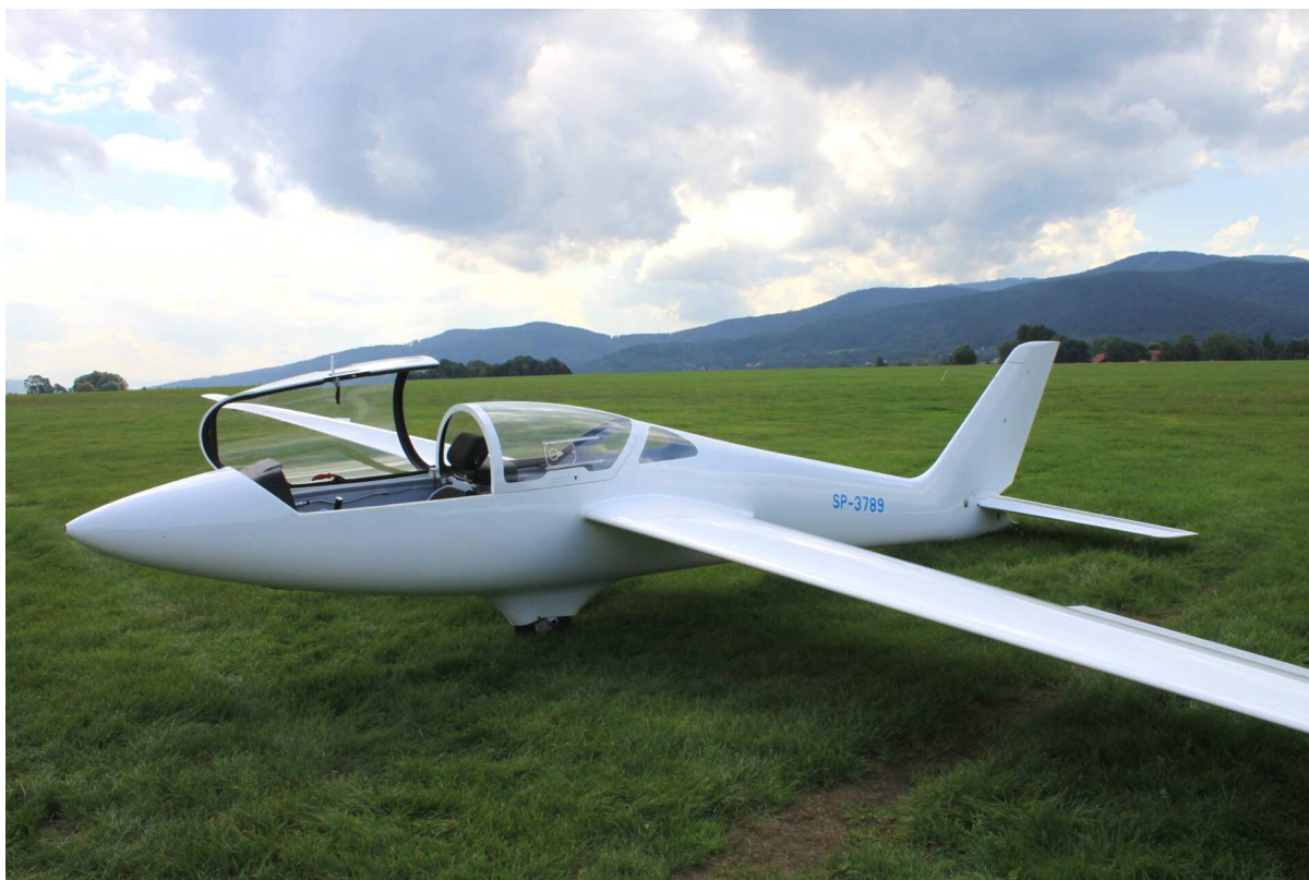
Fot. 5. Kompozytowy szybowiec MDM-1 „Fox”, produkowany w Bielsku-Białej [34]
