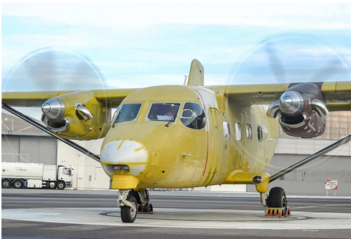
Fot. 6. Samolot M28 z gondolą metalową (na prawym skrzydle) i kompozytową (na lewym skrzydle) [43]
