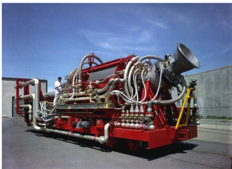
Rys. 7. Testowy jądrowy silnik strumieniowy Tor-II-C [10]
