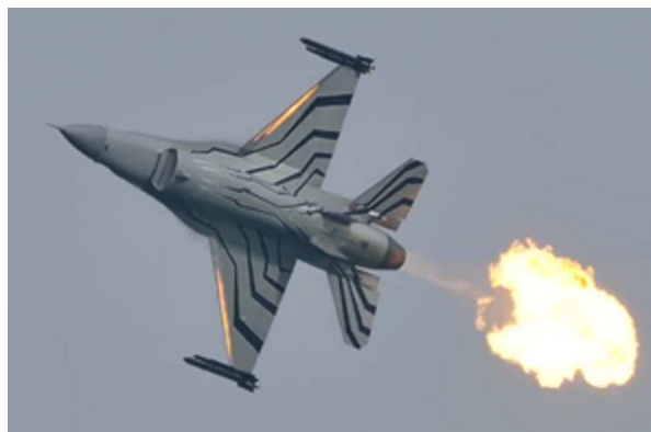
Rys. 1. Wyrzut płomienia w wyniku pompażu silnika samolotu F-16 [1]
