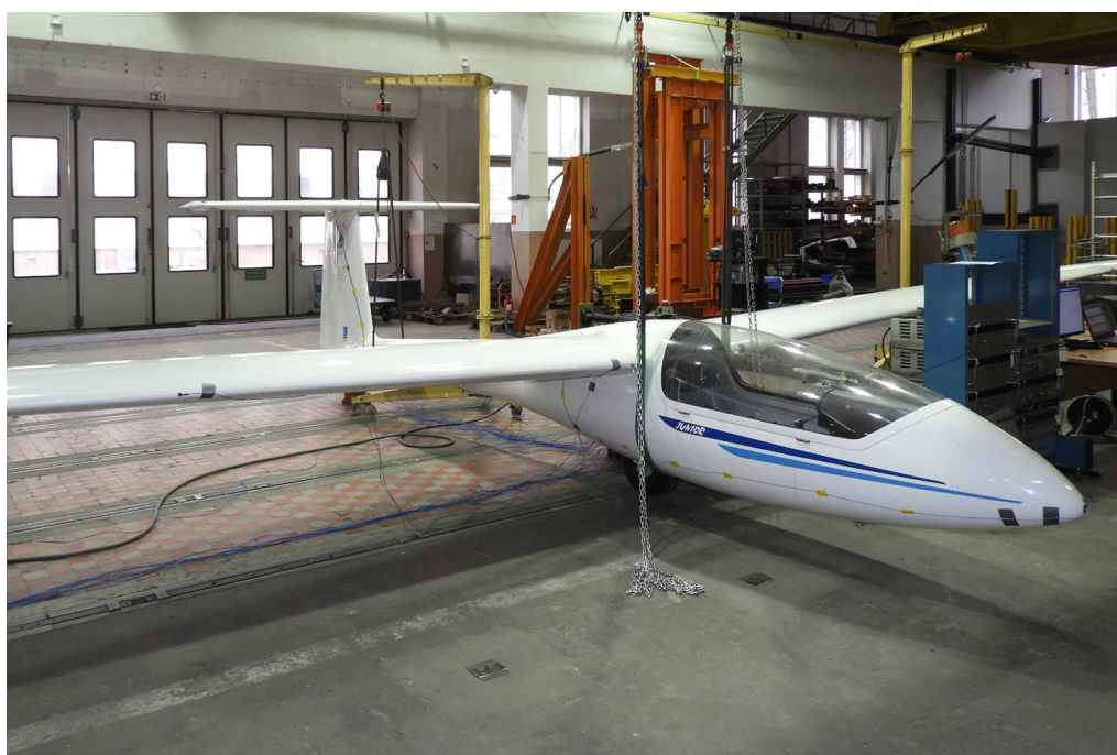
Rys. 3. Badania rezonansowe szybowca SZD-51 Junior w hali ILot (2021)
