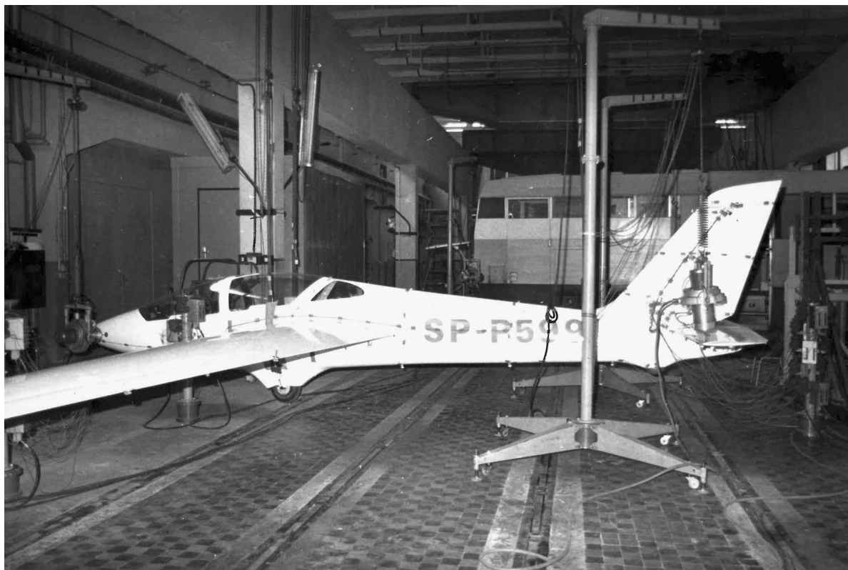
Rys. 1. Prototyp szybowca MDM-1 Fox podczas badań rezonansowych w ILot (1994 r.)
