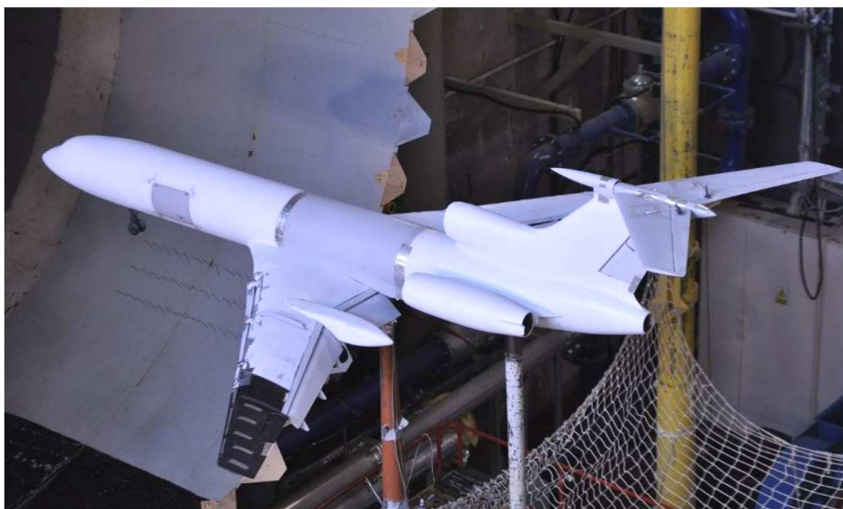
Rys. 3. Model samolotu Tu=154M w tunelu T-3
