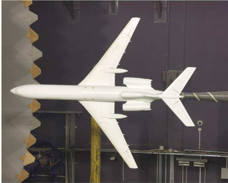
Rys. 3. Model samolotu Tu-154M w skali 1:20 w tunelu T-3 Instytutu Lotnictwa
