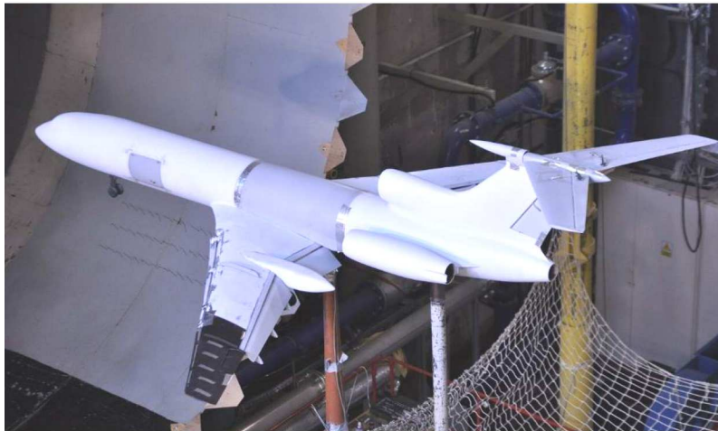
Rys. 4. Model samolotu Tu=154M w skali 1:14 w tunelu T-3
