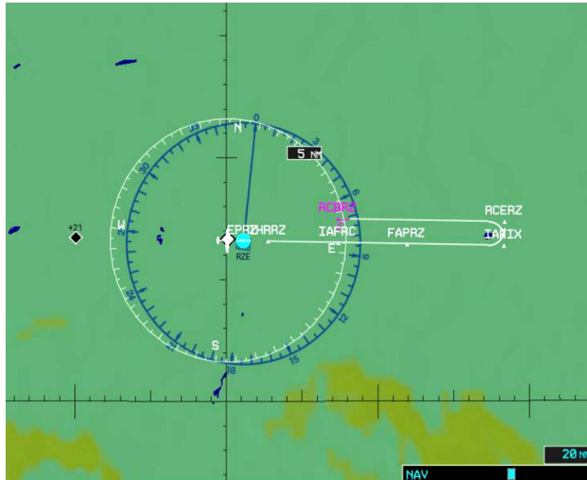
Rys. 9. Środowisko symulacji X-plane11 – przykład: implementacja procedury referencyjnej podejścia dwuzakrętowego „racetrack”
